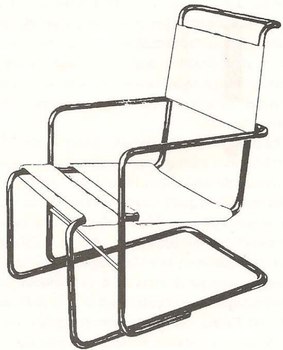
Figura 8: Silla, de Marcel Breuer. Breuer apela a la doble pata ya propuesta por Stam y recupera el concepto de eliminación de las cuatro patas, por lo menos en lo perceptivo. (Dibujo extraído de Russell, Garner y Read 1980).
