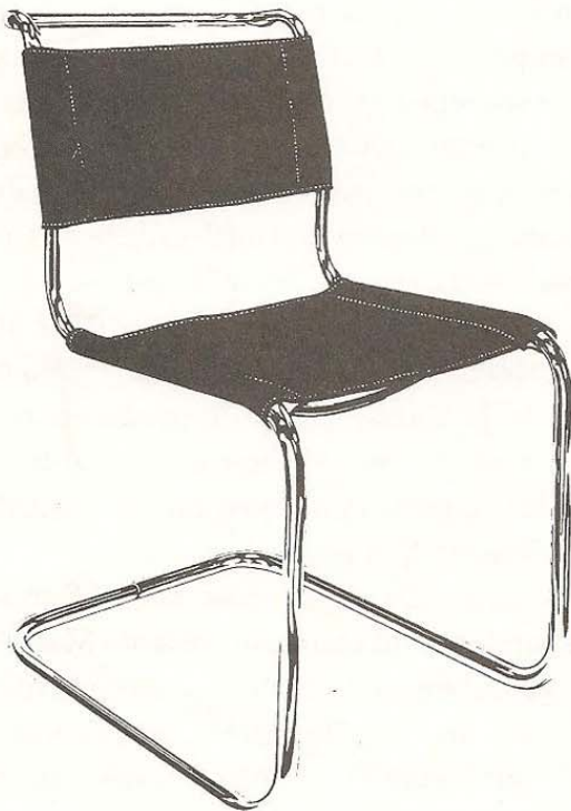
Figura 3: Silla S33, de Mart Stam. La silla de Stam, por ser la primera de la serie, otorga toda la fuerza a la estructura, y los elementos de asiento y respaldo necesitan de ella para funcionar. (Dibujo extraído de Russell, Garner y Read 1980).
