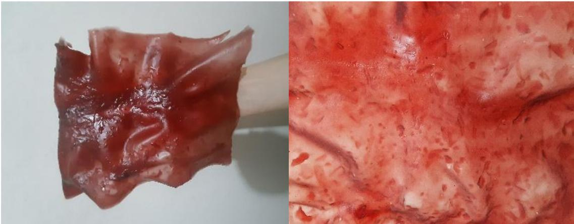
Para generar alternativas en el campo del hábitat, se reciclan residuos celulósicos disponibles en el medio local con micelio de hongos para obtener un material orgánico bio-transformado que puede aplicarse en placas para aislación térmica y cerramientos (Fernández et al. 2022).
