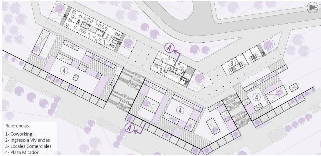
Figura 9. Croquis del Edificio de viviendas y de cada programa que compone su planta baja pública
