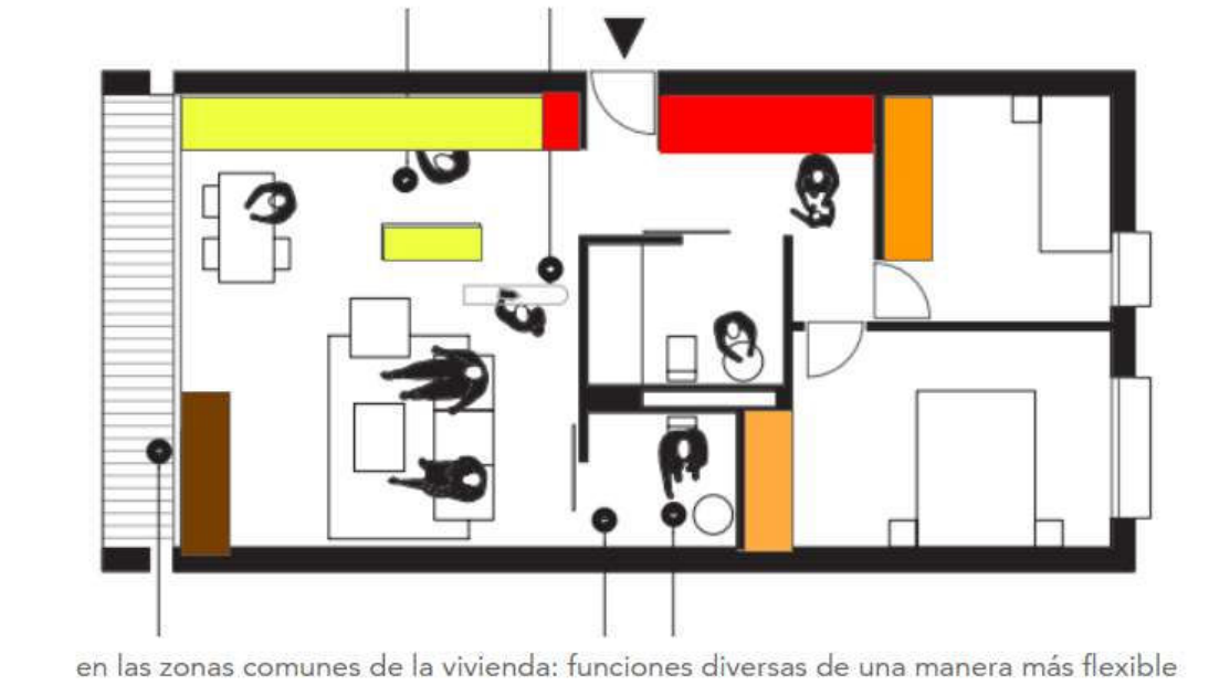
Figura 20: Diversidad y flexibilidad en los espacios de guardado. Fuente: Esquemas de elaboración propia sobre ilustración en planta publicada en la revista Qüestions d'Habitatge n22
