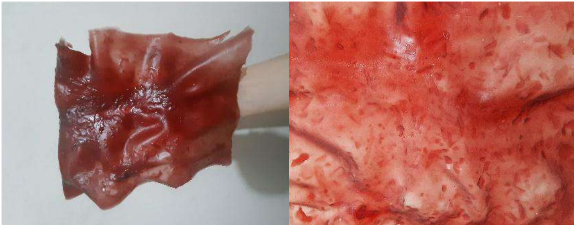
Figura 3. Desarrollo de materiales aislantes en base a micelio fúngico. Fuente: Elaboración propia.
