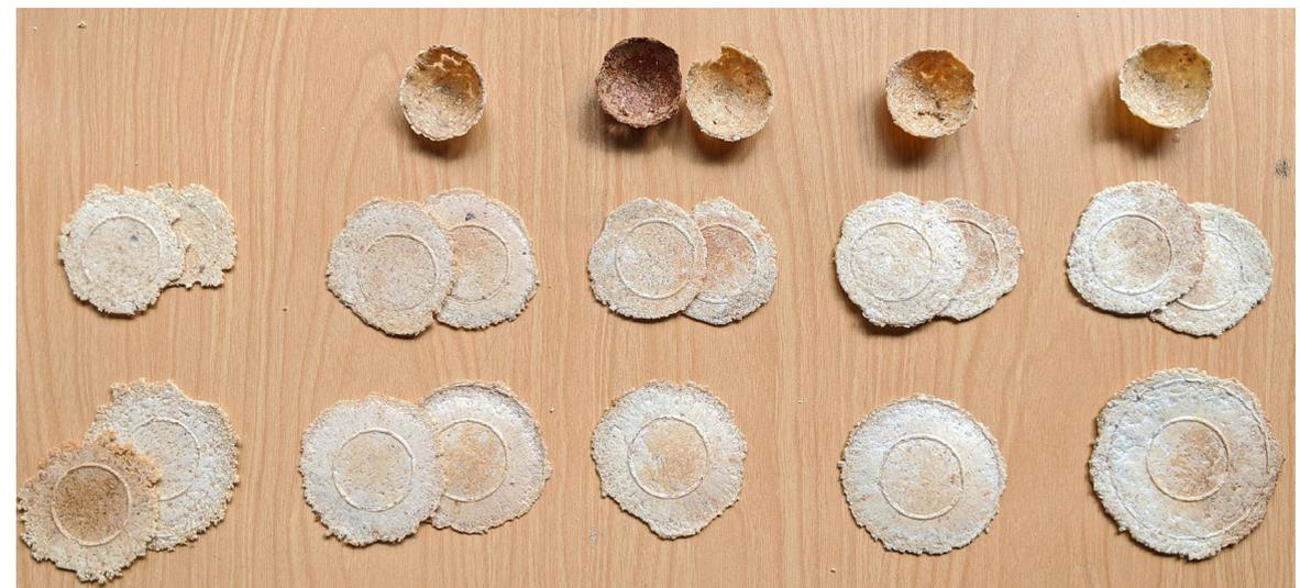
Figura 9: Muestras laminares procesadas con la plancha caliente, y moldeadas semi esféricamente procesadas en el horno. Las concentraciones de harina de trigo varían del 10% al 50%, de izquierda a derecha.
