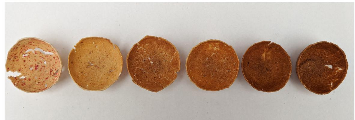
Figura 11: Degradación de color debido al tiempo de horneado de muestras moldeadas de forma semiesférica. De izquierda a derecha los tiempos de horneado fueron: 17, 20, 23, 26, 29 y 32 minutos.
