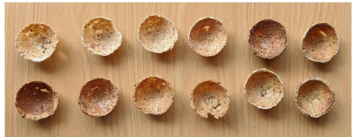
Figura 10: Muestras semiesféricas procesadas en el horno a 180 °C. Los espesores de izquierda a derecha son: 0.5, 1, 1.5, 2, 3 y 4 mm. En la parte superior la concentración de harina de trigo fue del 30% y en la inferior del 40%.
