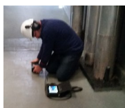
3- Ensayo combinado: ultrasonido mas georadar.
