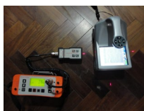
6- Georadar y detector magnético de armaduras
