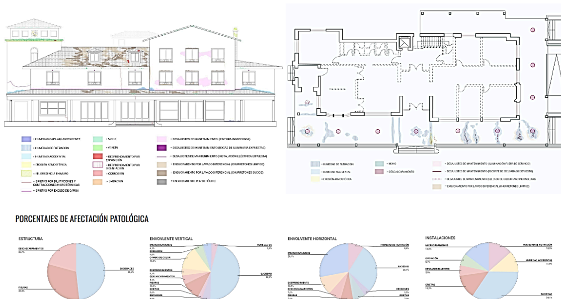
Figura 7: Mapeo de síntomas patológicos
