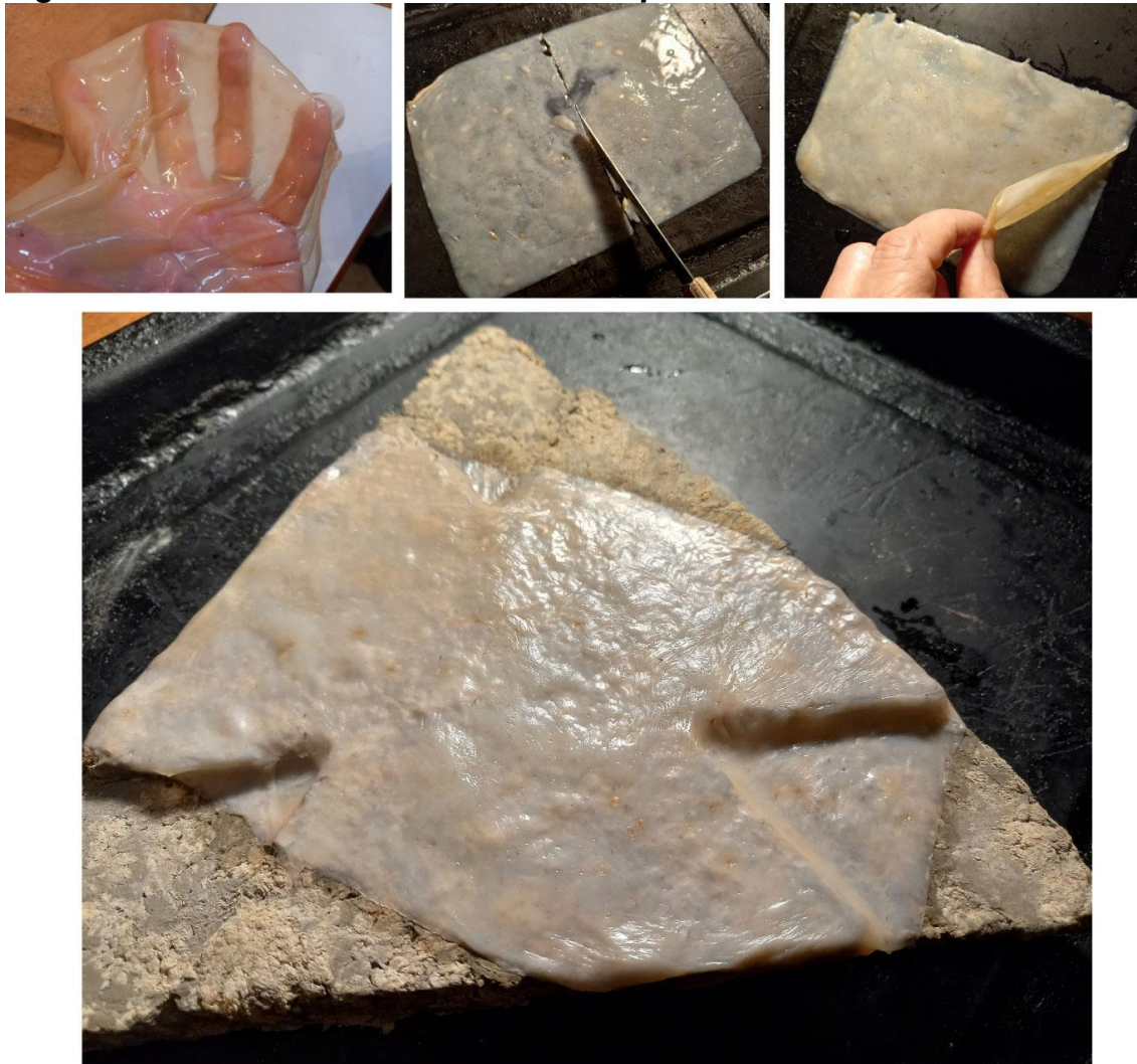
Figura 4: adhesión de membrana doble a placas de PC con relieve
