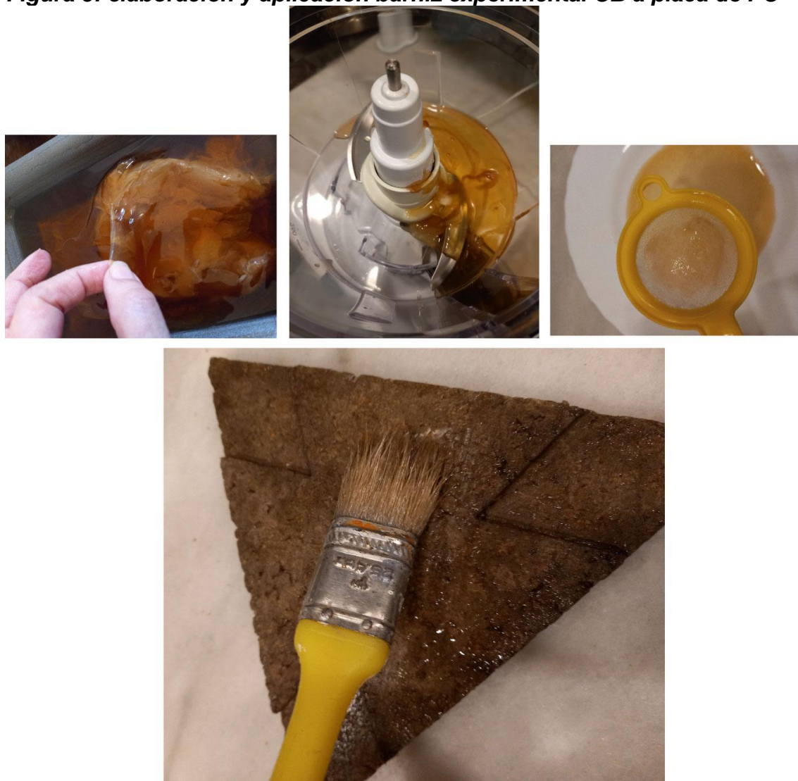
Figura 5: elaboración y aplicación barniz experimental CB a placa de PC
