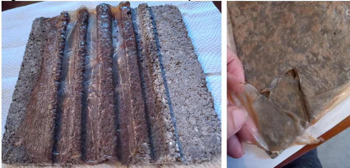
Figura 3: adhesión de membrana fina a placas de PC con relieve
