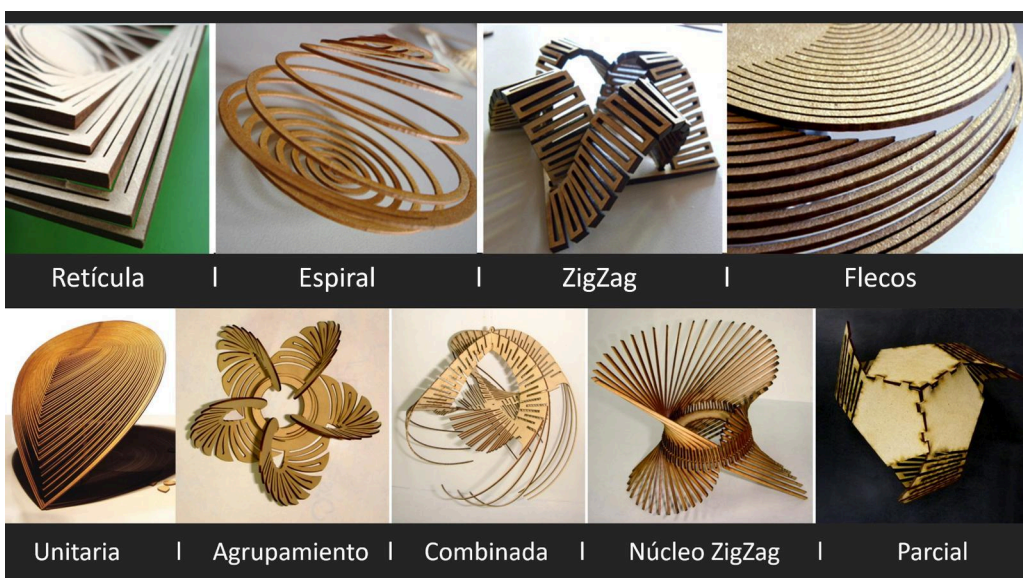
Figura 3: Categorías y estrategias de aplicación para diseñar a partir de la flexibilización de placas rígidas
