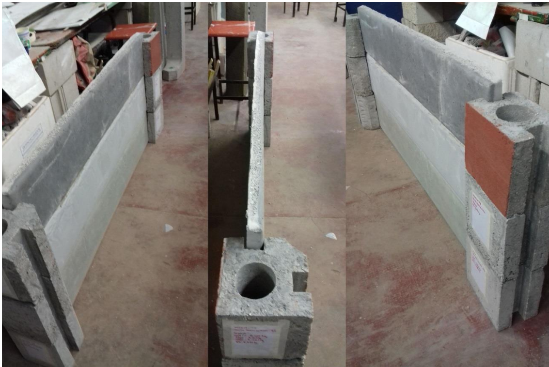
Figura 2.- Armado parcial del Sistema USSU para verificación de placas y bloques columnas. Fuente propia.
