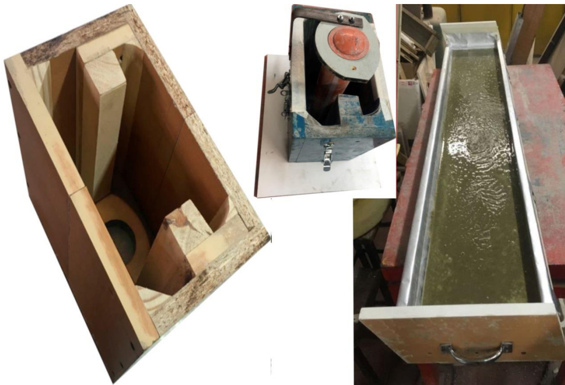
Figura 5:- Encofrados de madera para bloques y placa USSU. Fuente propia.
