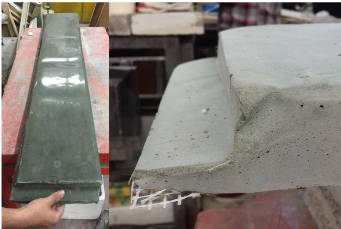
Figura 3.- Placa con saliente para mejor encastre a los bloques columnas y mejor terminación. Fuente propia.
