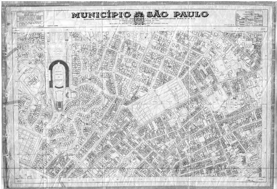
Figura 7: Município de São Paulo , Vasp Aerofotogrametria S. A. e Serviços Aerofotogramétricos Cruzeiro do Sul S. A. , 1954. Conocido como relevamiento Vasp/Cruzeiro, vemos en la imagen la hoja 13-14, en escala 1:2000. Fuente: Arquivo Histórico Municipal/Prefeitura do Município de São Paulo .
