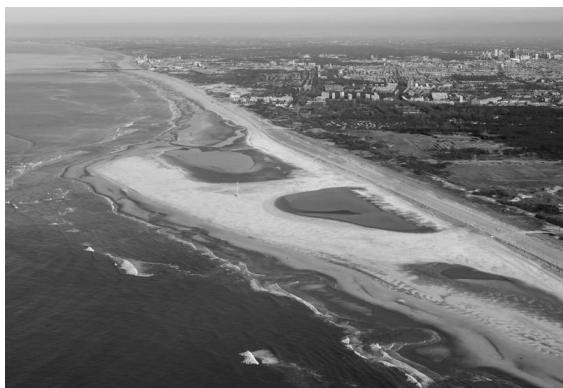
Figura 4: The Sand Engine, provincia de Zuid Holland. El diseño de la duna expandida en forma de península se modela mediante la acción de mareas y vientos, para progresivamente extenderse a lo largo de la costa como buffer de protección ante tormentas y alza del nivel del mar. En la secuencia de fotografías aéreas se observa el proceso de construcción durante: a) 15 de Marzo, 2011; b) 25 de Marzo, 2011; c) 25 de Abril, 2011; d) 17 de Mayo, 2011; e) 14 de Junio, 2011; f) 11 de Julio, 2011. Fuente: Zandmotor. Recuperado de: https://www.dezandmotor.nl/
