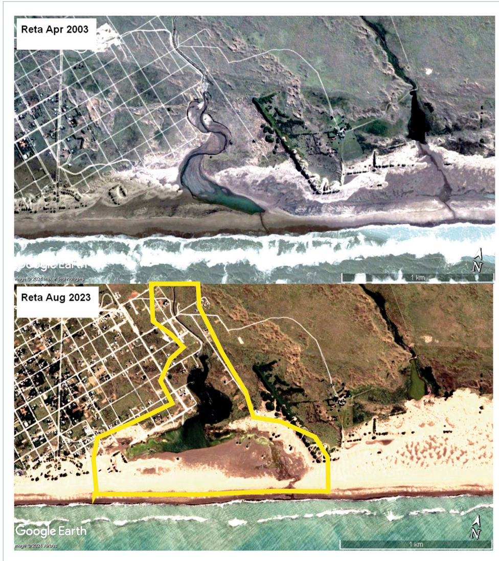
Figura 5 Comparación de imágenes TM de 2003 y 2023 que muestra la expansión urbana de la localidad de Reta hacia la laguna costera. El polígono amarillo representa el área que, de acuerdo con el Código de Aguas, debería estar sujeta a restricciones para la construcción. Fuente: modificado de Luis Piccinali (2013).
