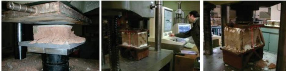
**Figura 4.** Ensayos destructivos en los laboratorios del INPRES: de mampuestos individuales (*Der.*) y unidades de traba del aparejo compuesto (*Centro e Izq.*). Fotos: *Blasco Lucas I.*
