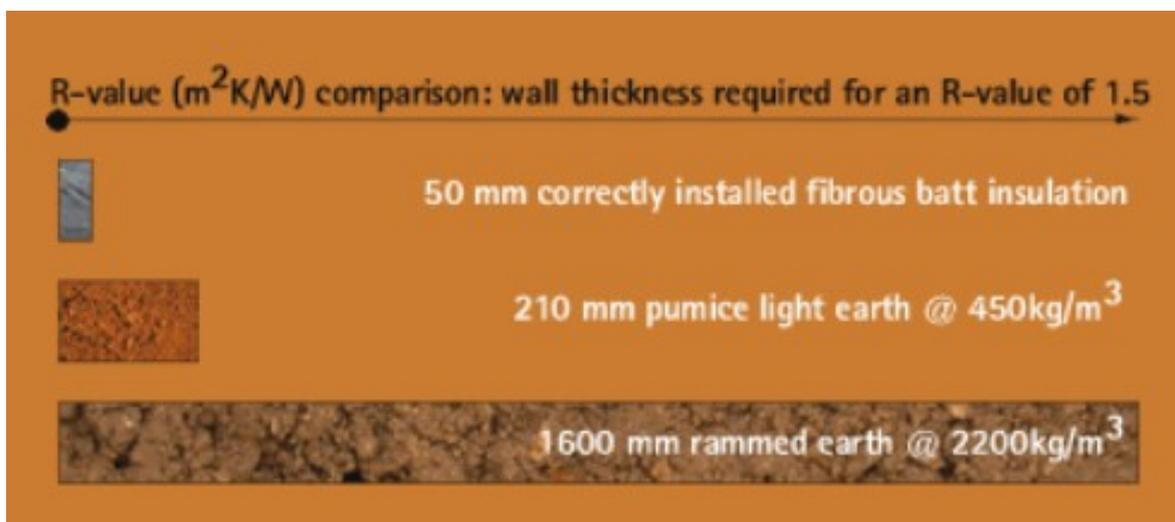
El valor **R** (m<sup>2</sup>K/W) describe la Resistencia Térmica de un muro al flujo de calor con una diferencia de temperatura en cada cara. Los coeficientes recíprocos de la cantidad de energía (W) viajando a través de 1m<sup>2</sup> de muro a una diferencia de temperatura de 1° C entre el interior y el exterior (1K) descrito por el Valor U europeo (W/m<sup>2</sup>K).
