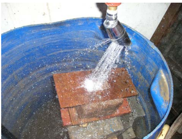
Fig. 1: Ensayo de chorro de agua
