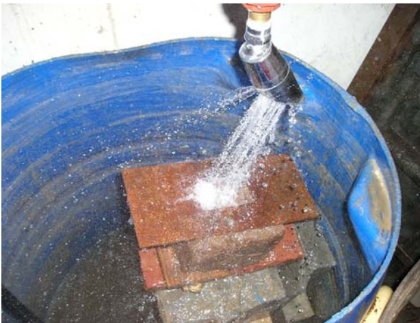
Fig. 1: Ensayo de chorro de agua
