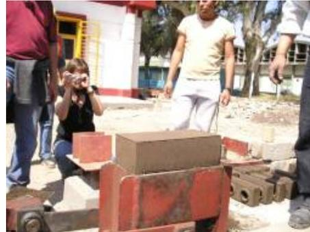
Figura 12: Extracción bloque  $0,14 \times 0,29 \times 0,09$  m.
