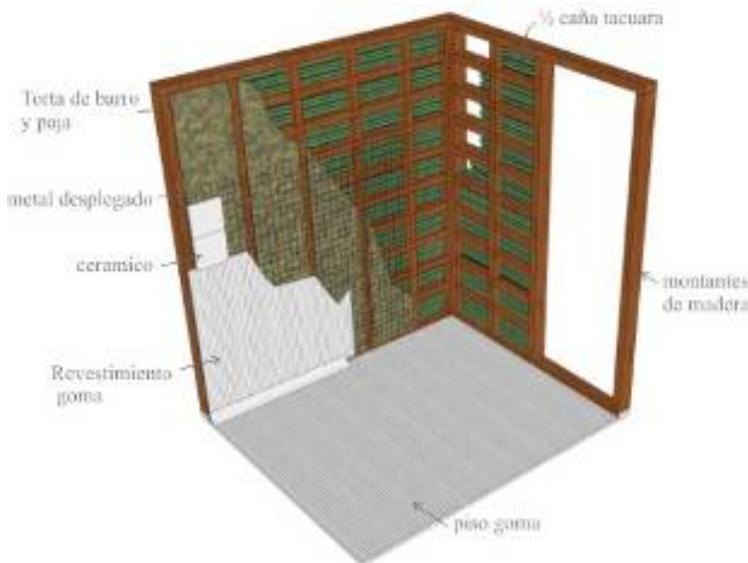
Figura 19: Paneles sanitarios con revestimiento de goma
