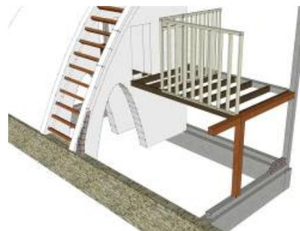
Figura 18: Unión del entrepiso de madera con la estructura
