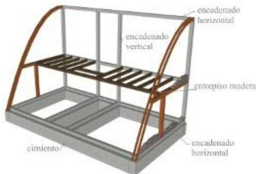
Figura 17: Estructura de madera en los muros de cierre
