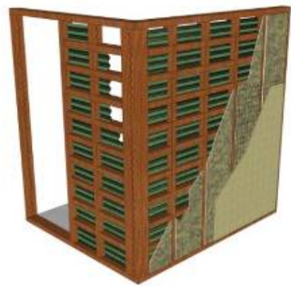
Figura 20: Panel con montantes cada 0,40 m. con 1/2 cañas de tacuara en su interior
