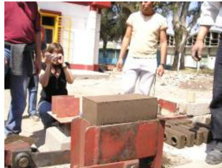
Figura 12: Extracción bloque 0,14 \times 0,29 \times 0,09 m.
