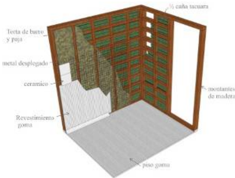
Figura 19: Paneles sanitarios con revestimiento de goma
