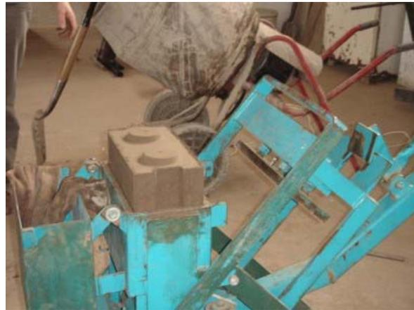
Figura 3: Prensa manual para BTC
