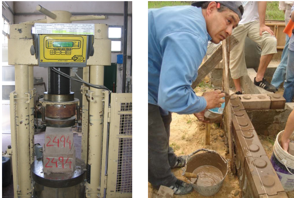
Figura 5: Controles de calidad (ensayo de resistencia mecánica); control durante la ejecución de muros.
