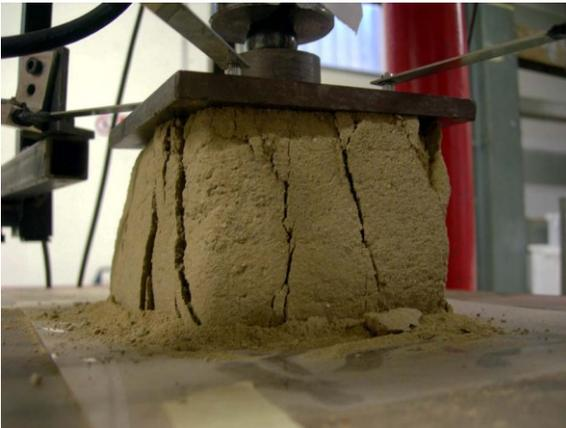
**Figura 4.** Pruebas de compresión de ladrillos de adobe.
