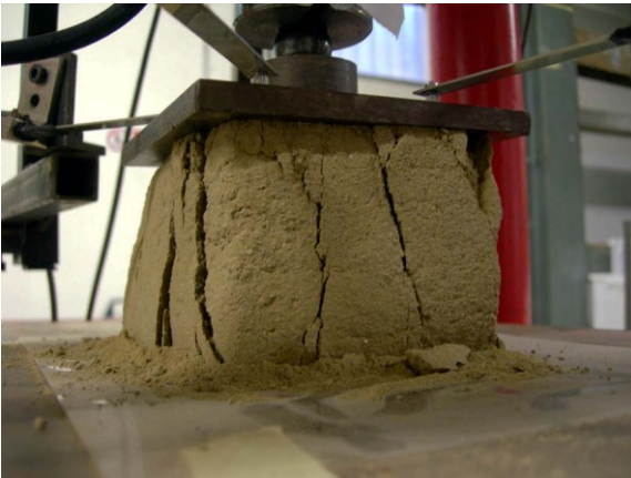
Figura 4. Pruebas de compresión de ladrillos de adobe.
