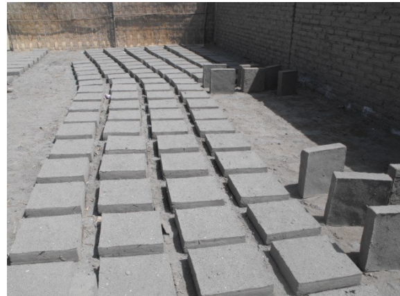
Figura 5. Fabricación de adobes normalizados.
