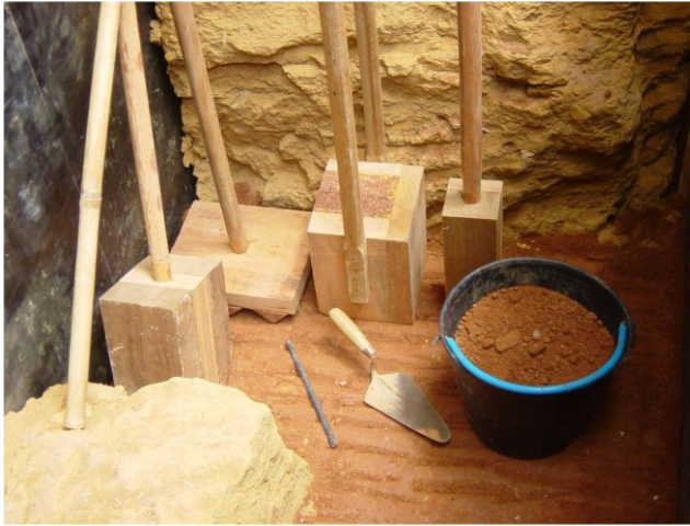
Figura 8. Todos los pilones empleados en la compactación y sus dimensiones, Tabla 6.
