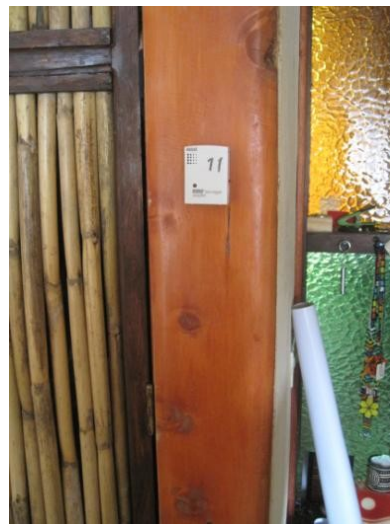
Figura 5. Ubicación del Hobo 11, en el dormitorio 2, a 1,20 m de altura.
