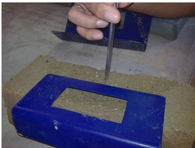
**Figura 10.** Medición de erosión en BTC, grupo experimental, 1 hr., (foto: Yolanda Aranda).
