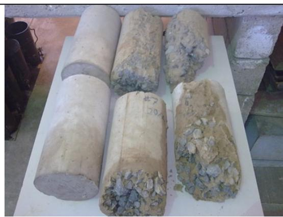
**Figura 6.** Resultado de la prueba de erosión de izquierda a derecha, D2, D3, C4, (foto: Yolanda Aranda)
