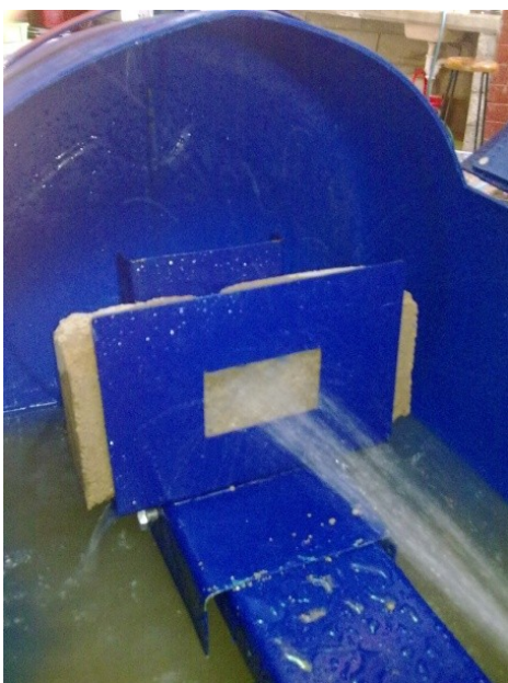
Figura 9. Prueba de erosión en BTC, grupo experimental, 1 hr., (foto: Aranda)
