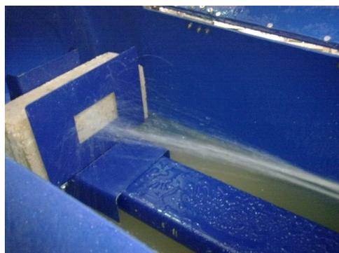
**Figura 8.** Prueba de erosión en BTC, 30 min. grupo control, (foto: Yolanda Aranda).
