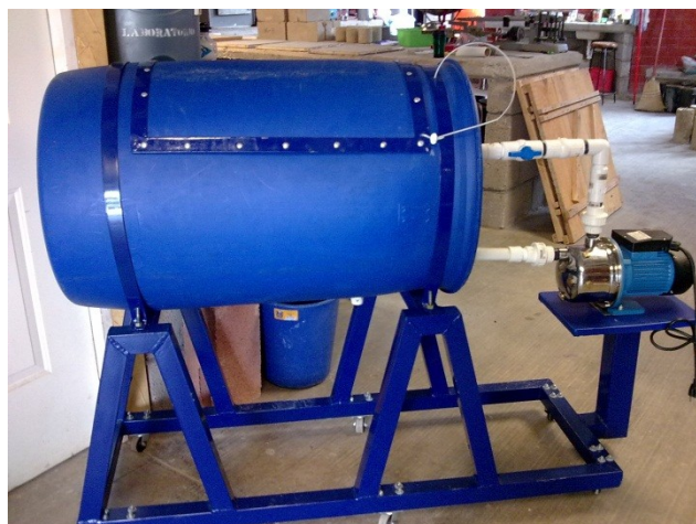
Figura 4. Tanque de chorro de agua (foto: Yolanda Aranda)
