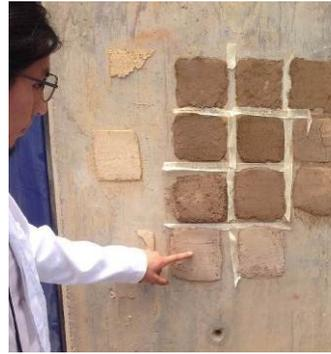
**Figura 5.** Todas las probetas soportaron sin problema la temporada de huracanes del 2015 y permanecen estables a pesar de haberse colocado sobre una superficie lisa de hormigón. Laboratorio de Materiales de la UAM-Xochimilco.
