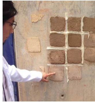
Figura 5. Todas las probetas soportaron sin problema la temporada de huracanes del 2015 y permanecen estables a pesar de haberse colocado sobre una superficie lisa de hormigón. Laboratorio de Materiales de la UAM-Xochimilco.
