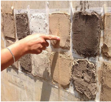
Figura 4. Pruebas preliminares para determinar la cantidad de áridos necesarios para evitar la retracción de los revoques. Laboratorio de Materiales de la UAM-Xochimilco.
