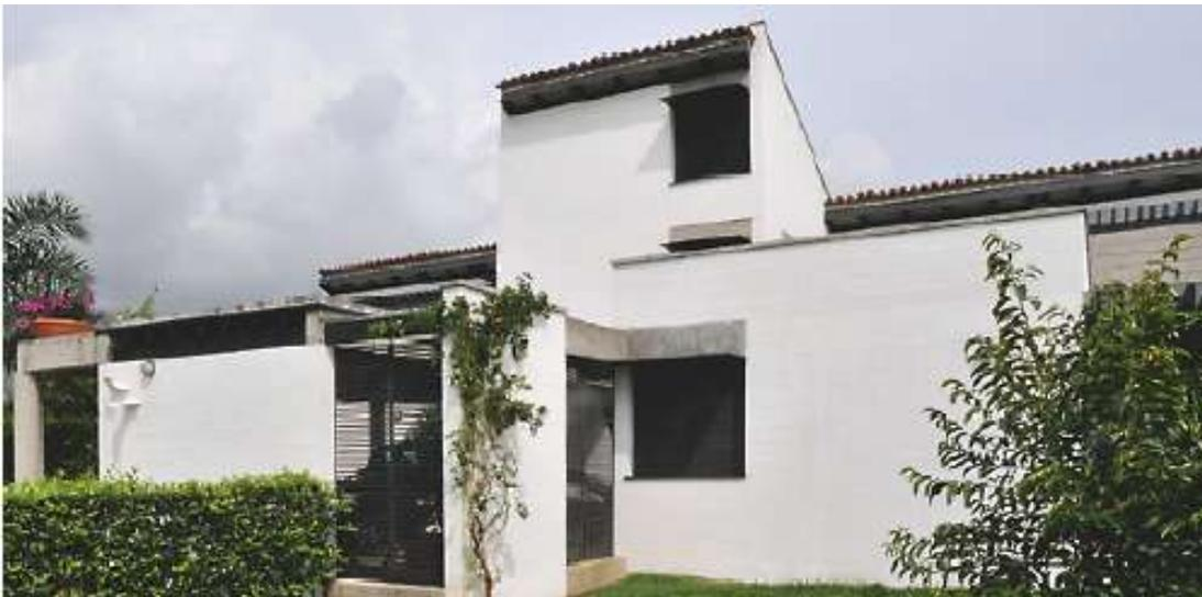
**Figura 9.** Casa de las aves, cerca de Cali, muros cargueros de bloques rellenos con tierra (2008) Arq. BBC
