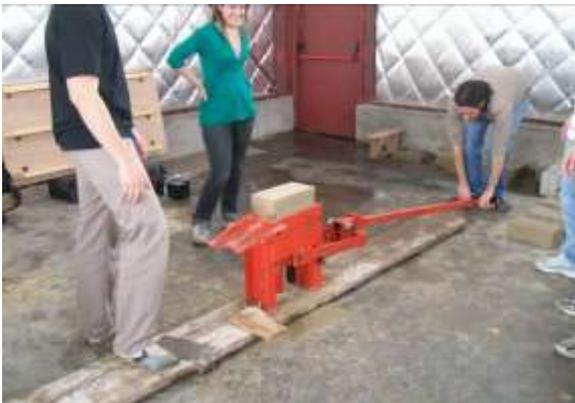
**Figura 7** - Fabricando BTC
