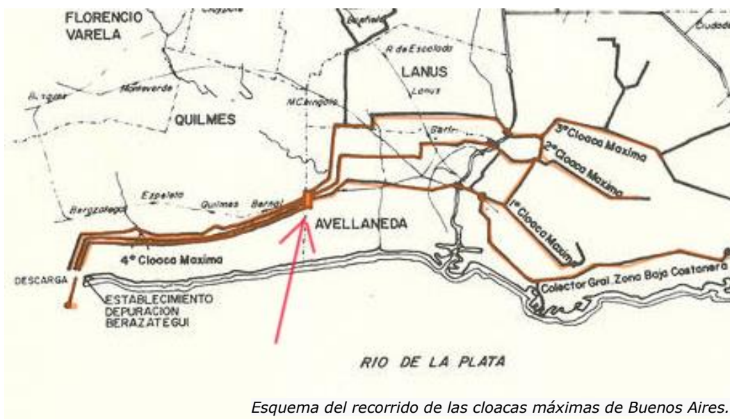
Plano General de la Cloaca Máxima del nuevo Sistema y sus Ramales. Fecha en que se construirán las obras de provisión de Agua y Cloacas en los diversos barrios (Sin Fecha) Fuente: Archivo de Redes, AySA
