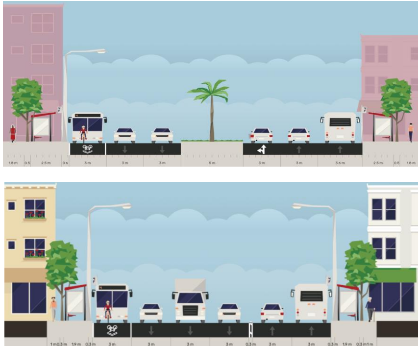
Figura 3. Secciones transversales típicas de Av. Güemes y Av. Belgrano. Fuente: Elaboración propia utilizando la herramienta online de Streetmix.net.
