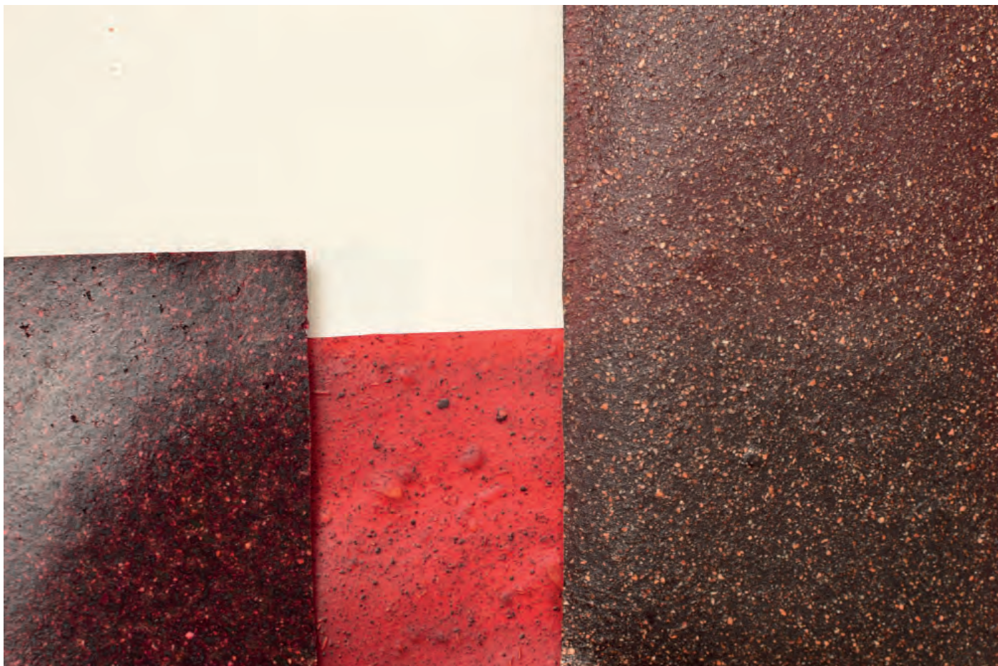
Etimo. Experimentaciones con biomateriales 100% biodegradables de permeabilidad variable.
